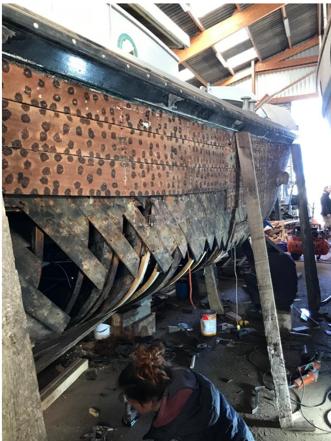
Les bordés abimés sont démontés puis la première couche de bordés intérieurs à 45° est refaite
