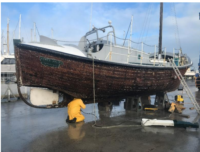
Le canot est sablé ( 600kg de sable ont été nécessaires ! )
