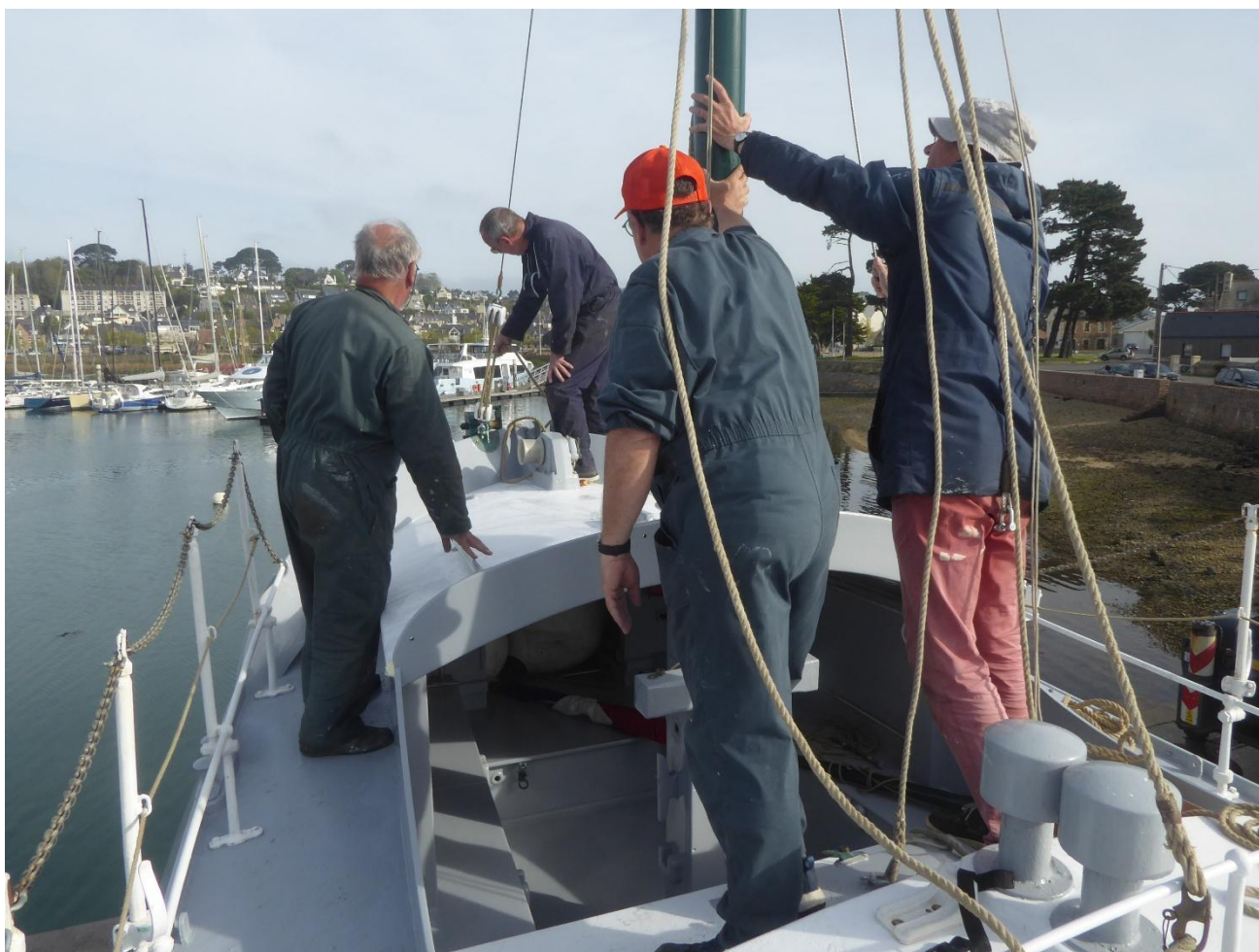
Le mat est remis en place
